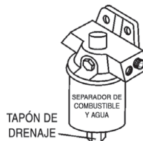
La figura 15. Filtro separador de combustible y agua
