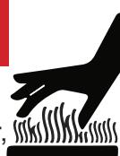
Si agrega una mezcla de enfriador/anticongelante al radiador, NO retire la tapa hasta que esté completamente frío. Existe la posibilidad de que el enfriador este caliente y pueda causar severas quemaduras. La adición del refrigerante se hace día a día desde el tanque de recuperación. Cuando agregue enfriador al radiador, NO quite la tapa del radiador, hasta que la unidad este completamente fría. Consulte la Tabla 2 para la capacidad del motor y el radiador.
