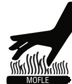
**·NUNCA** toque el tubo de escape, el silenciador o el cilindro, cuando estén calientes. Permita que estas partes se enfrien, antes de dar servicio al motor o al generador.
