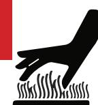
**NUNCA OPERE** el motor con las cubiertas calientes o sin los protectores de calor.
