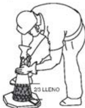
Figura 68-B. Prueba de asentamiento (2/3 lleno)
