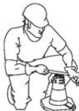
Figura 68-D. Prueba de asentamiento (Remove el exceso de concreto)
