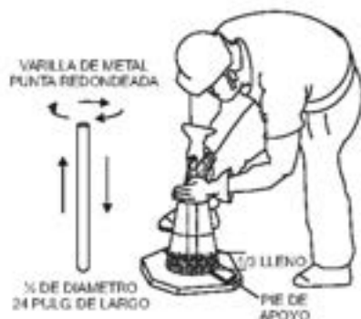
Figura 68-A. Prueba de asentamiento (1/3 de lleno)
