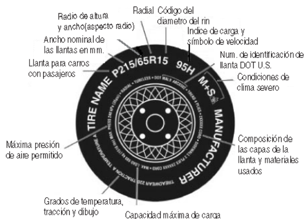
Figura 57. Información estandar de la pared lateral de la llanta
